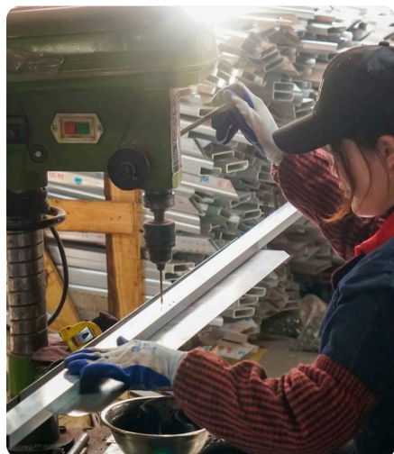
Door frame drilling
